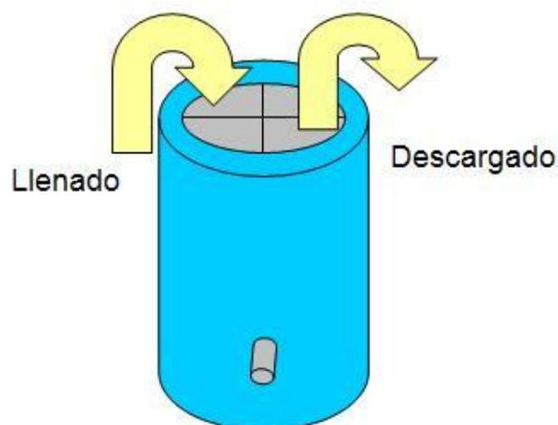
**Figura 23: Esquema de un biodigestor discontinuo (RMR PRIDGEDS).**
