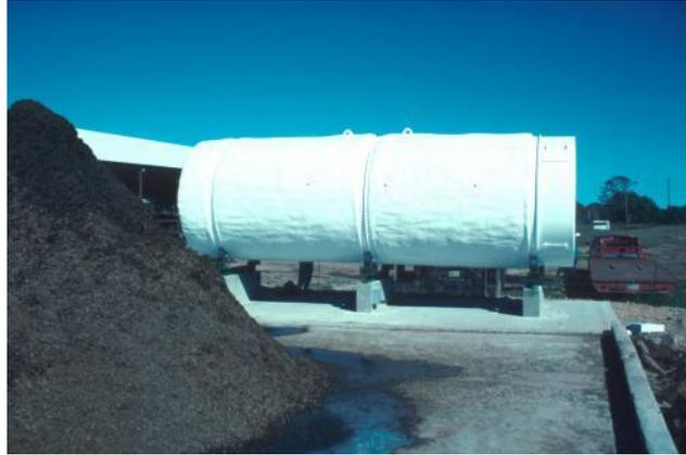
Figura 20: Compostaje en reactores (EPA, 1995).
