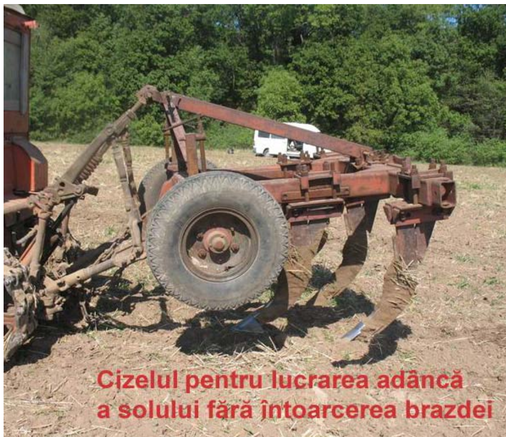
Agregat pentru afânarea adâncă a solului fără întoarcerea brazdei de tipul PINOCCHIO
