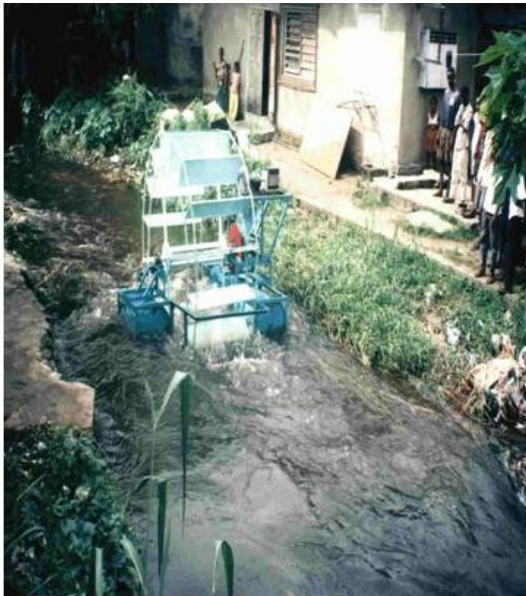
Figure 2 : Hydraulienne dans la Tsiémé (fabrication locale)
