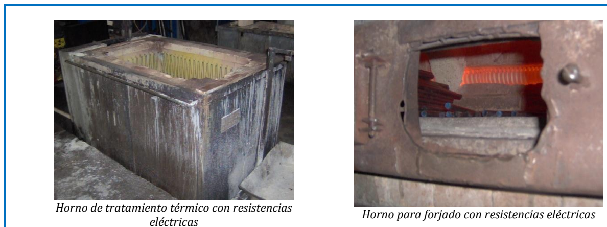
Figura 9 Sistemas de calentamiento con resistencias eléctricas.
