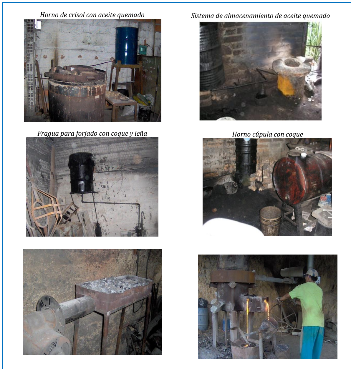
Figura 8 Sistemas de combustión con combustibles atípicos
