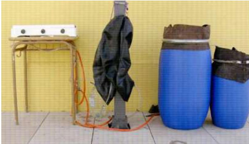
**Figure 16. Schéma de principe d'une petite cuisine au biogaz**
