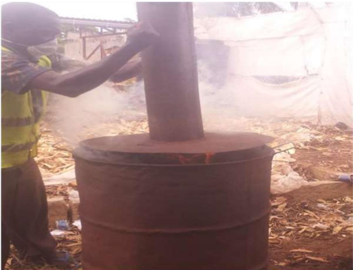
Figure19. Four à carbonisation des briquettes de la biomasse
