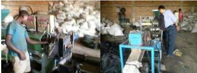
Figure21. Machine broyeuse et pour filature des plastiques fondus
