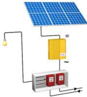
Figure1. Structure d'une installation solaire photovoltaïque
