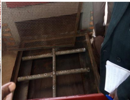
Figure 26 : Répartiteur d'air du four
