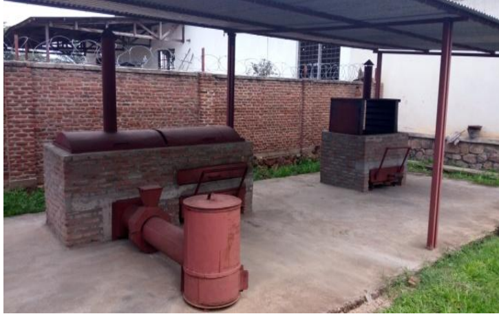
Figure 24 : Exemple de dispositifs du four FTT (DEPA, 2016)
