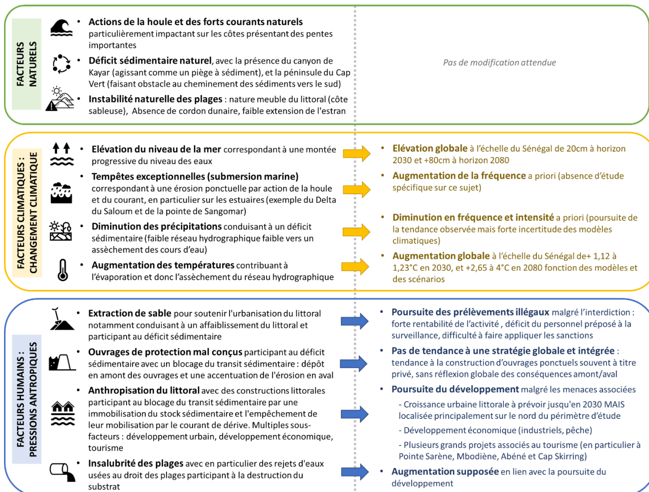
Figure 1 : Schéma de synthèse des liens de causes à effets de l'érosion et la submersion marine
