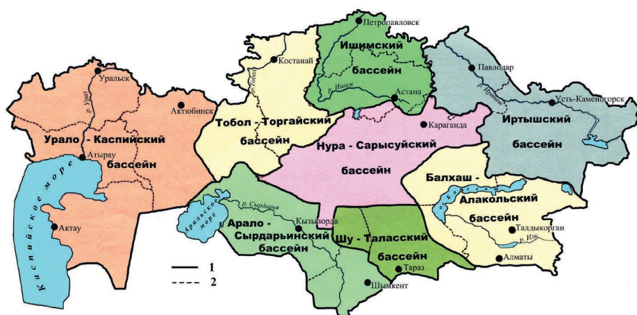
Рисунок 5.4.16. Схема расположения водохозяйственных бассейнов Республики Казахстан 1 - границы водохозяйственных бассейнов; 2 – границы административных областей
