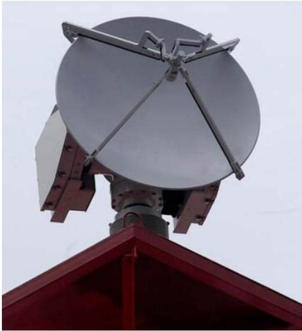
**Figura 5.3** Radar meteorológico del IMN.
