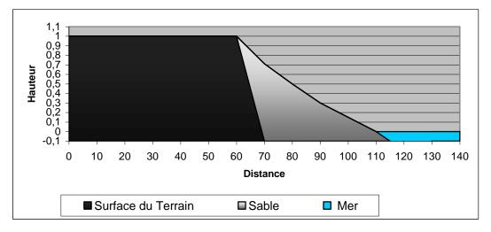
Figure 27 : Schéma de la ligne de côte de la plage Diogo Nunes (S. Tomé), position initiale du littoral en 1980 situé à 115 m du repère 0m
