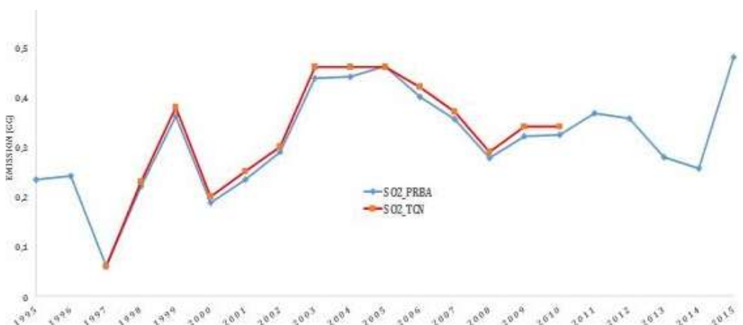
Figure 7- 69: Comparaison des émissions de tendance de dioxyde de soufre
